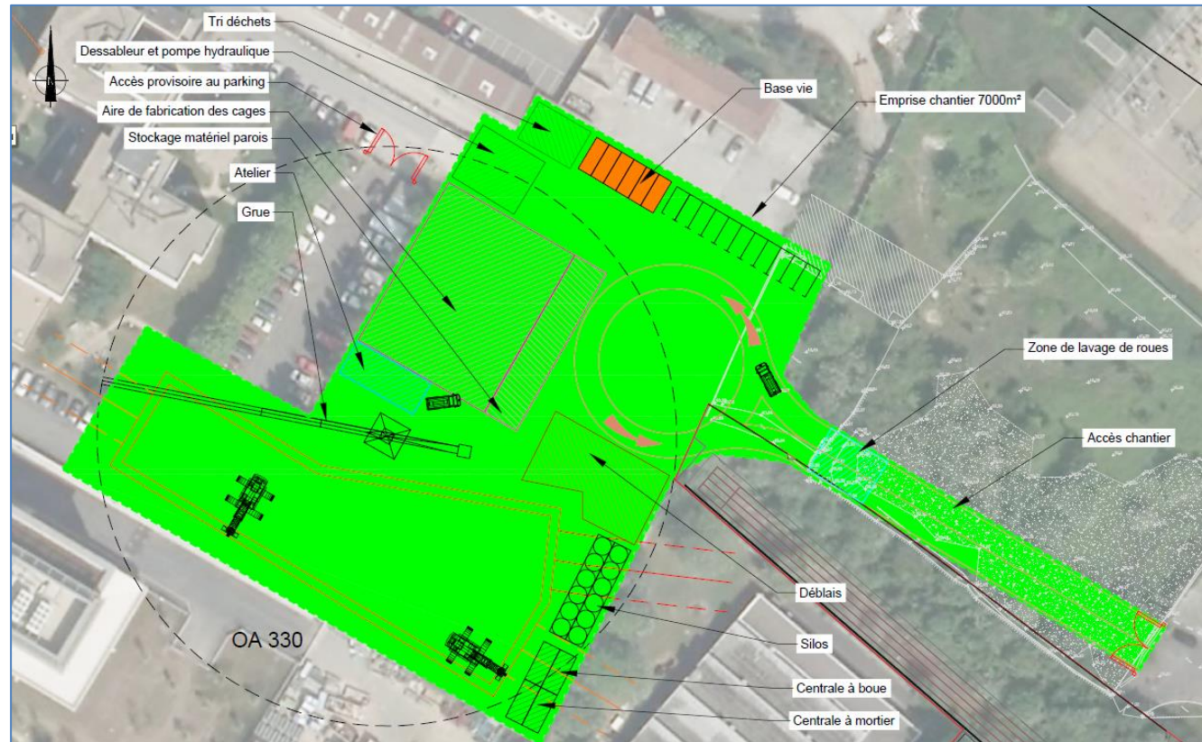
Ouvrage annexe 3300P - Bd Finot : plan masse de la phase chantier de réalisation des parois moulées (Egis / Tractebel, 2015)
