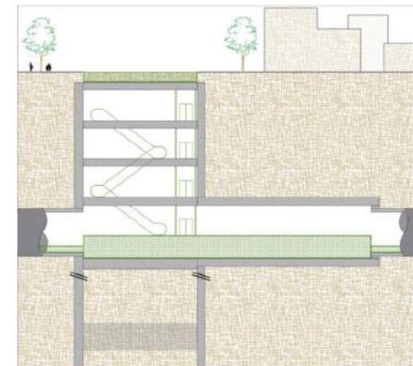
Phase 7 : Reconstruction de la voirie existante. Réalisation des ouvrages intérieurs dans l'ensemble de la gare
