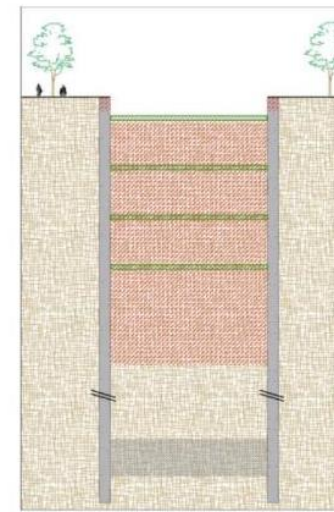
Phase 3 : Recépage des parois moulées, terrassement à ciel ouvert et pose progressive des butons provisoires
