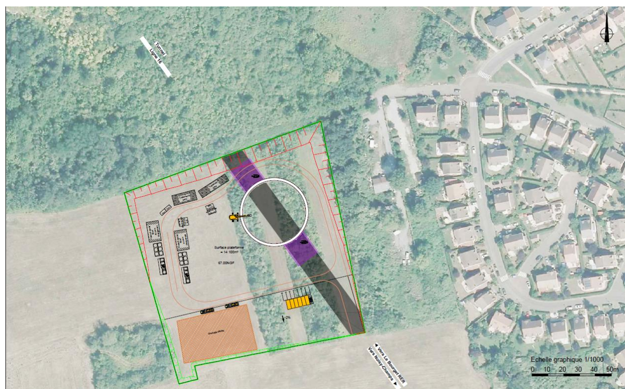
Ouvrage annexe 0603P - Chemin de la Peau Grasse : installations de chantier de l'ouvrage, phase de creusement du tunnelier 8 (Egis / Tractebel, 2015)
