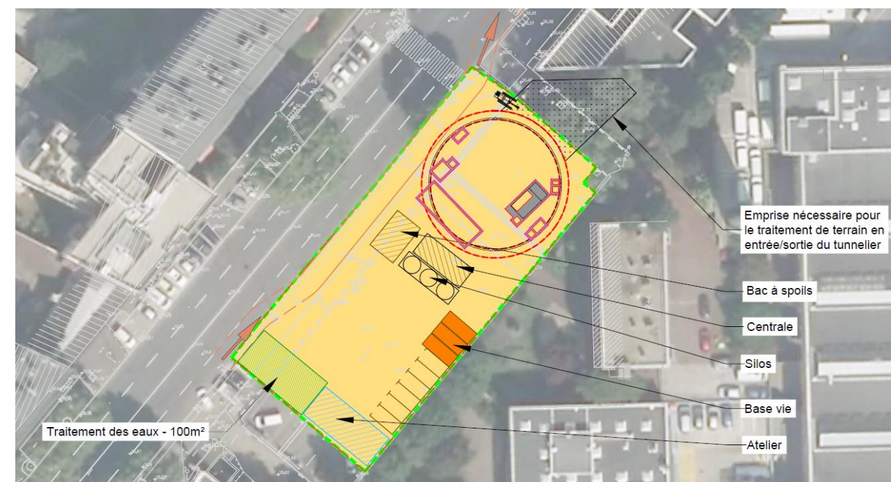
Ouvrage annexe 6302P - Bd A. France : plan masse de la phase chantier - réalisation du bouchon d'entrée du tunnelier (Egis / Tractebel, 2015)
